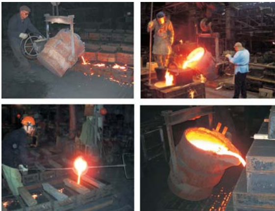
Նկ. 92. Լցման շերեփներով ձուլածների լցման եղանակները
