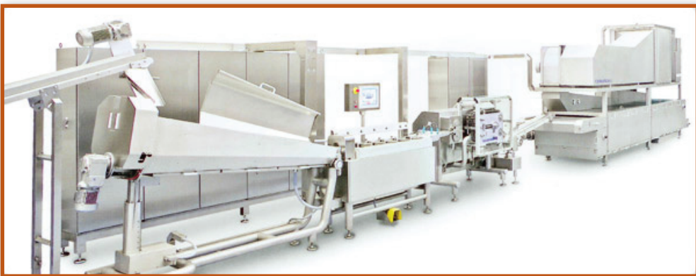
Նկար 76. Սառնաշաքարային և միջուկով կարամելի պատրաստման ավտոմատացված հոսքագիծ
