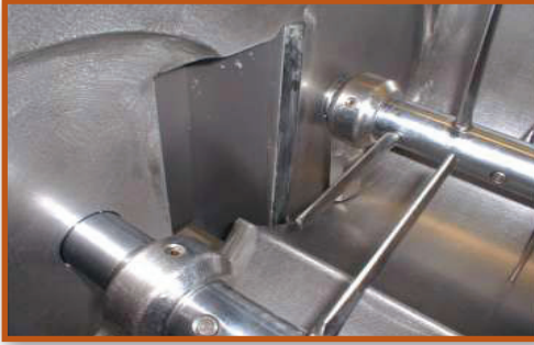
Նկար 110. Շնեկային մամլիչի թիակներով տաշտ
