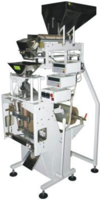
Նկար 121. Մակարոնեղենի կշռածրարման և փաթեթավորման կիսավարձարմար մեքենա (դրոպարոուկ)
